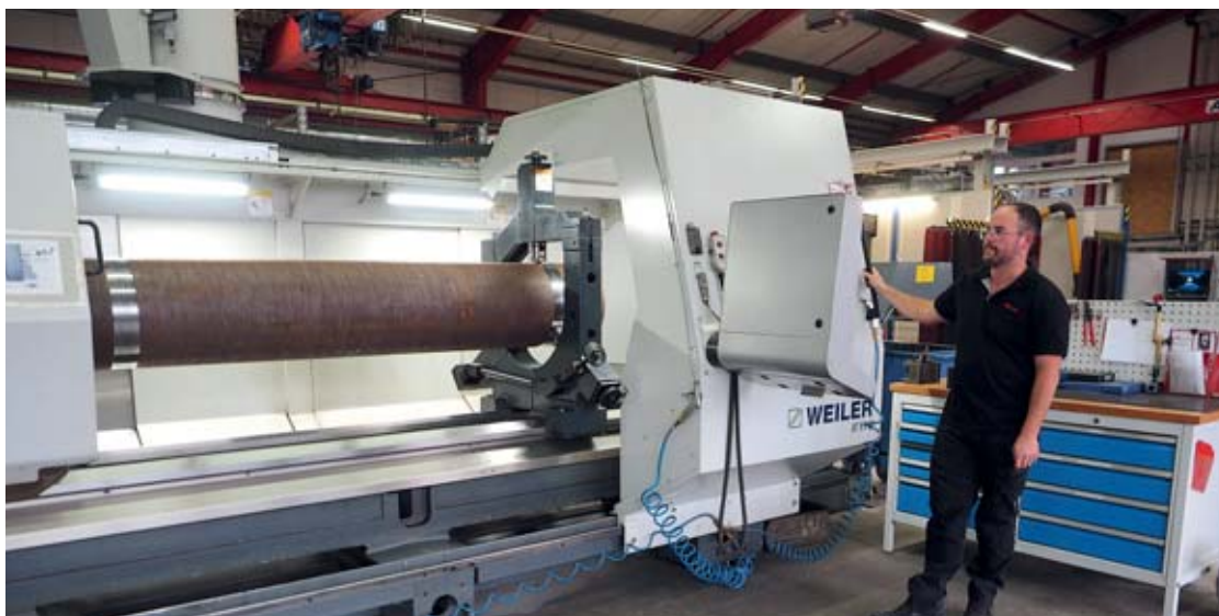
Rohrohre aus Baustahl mit Längen von 750 bis 2 500 Millimetern und Durchmessern zwischen 350 und 900 Millimetern müssen präzise und zuverlässig bearbeitet werden. Patrick Mannhart, Leiter Schlosserei und Teamleiter Rotorfertigung, beim Vordrehen der Rotorrohre auf der älteren E110.
