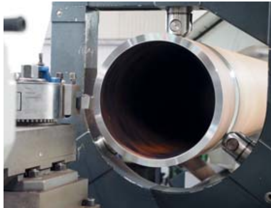
Das Vordrehen der Rohrohre auf der älteren E110 dauert bis zu einer Stunde, dabei ist die Zerspanung nicht zuletzt dank der zusätzlichen Lünette zuverlässig und präzise.
