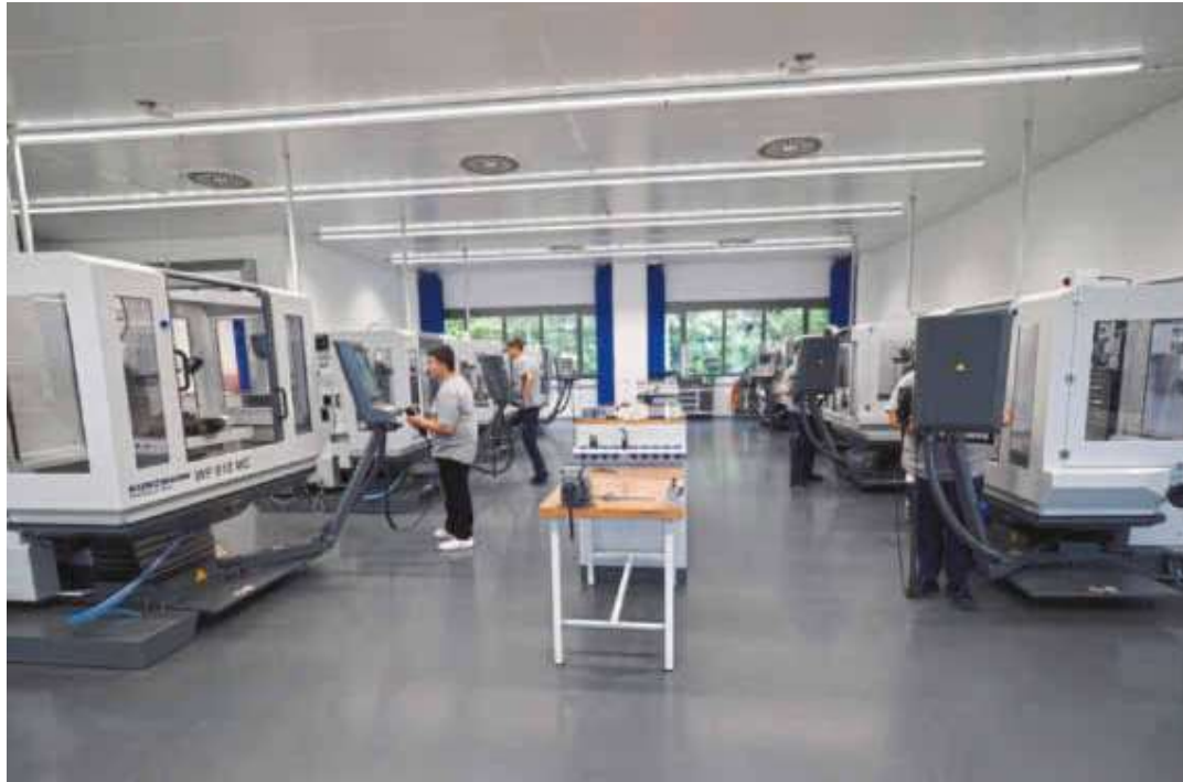
Insgesamt hat Varta acht Fräsmaschinen angeschafft – fünf rein manuell bedienbare WF 410 M und drei Hybridmaschinen der Typen WF 610 MC und WF 410 MC.
