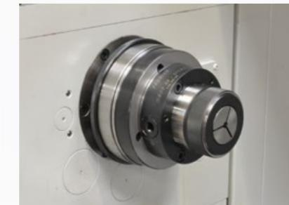
Handspannfutter für Druckspann- zangen
