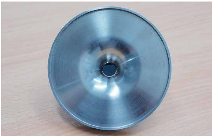
Im Fachbereich entstehen Bauteile für alle Arbeitsgebiete der PTB, hier beispielsweise ein Düsenkörper zur Erforschung des Strömungsverhaltens von Flüssigkeiten.
