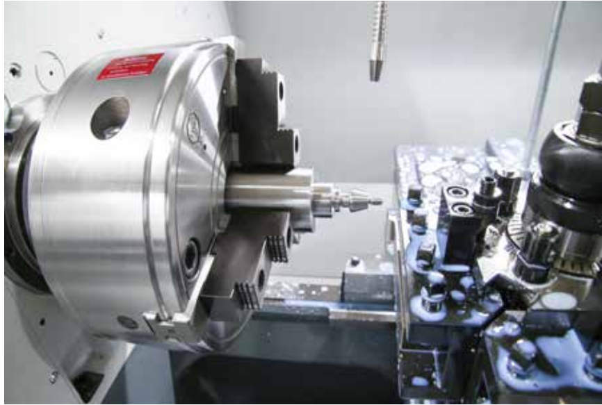
Die Zyklendrehmaschine wurde zusätzlich mit einem Parat-Werkzeugwechsler ausgestattet.
