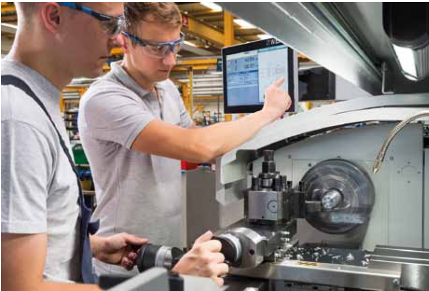
Bild 3: Auszubildenden sind die potentiellen Gefahrenquellen von Drehmaschinen in der Regel nicht bewusst. Wichtig ist beispielsweise eine gute Handhabung der Maschinen mit ergonomisch angeordneten Bedienelementen
