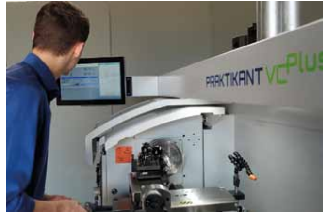
Bild 5: Der WTS-WEILER Touchscreen orientiert sich an der Bedienung von Tablets und Smartphones. Über verschiedene Apps lassen sich Daten rasch und bequem an dem 15-Zoll-Bildschirm eingeben und Anwendungen wie das Drehen von Kegeln oder das Gewindeschneiden starten
