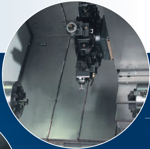
Arbeitsraum Ausführung mit Gegenspindel
