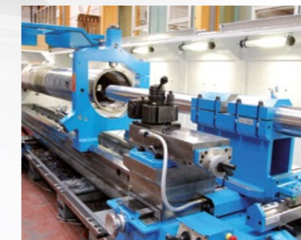
Verstärkter Bohrbock mit zusätzlicher Abstützung und Aufnahmebohrung 160 mm
