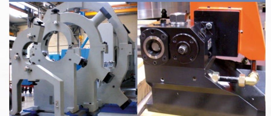
Werkzeugträgerkopf mit angetriebenen Werkzeugen, Aufnahme Capto C8
