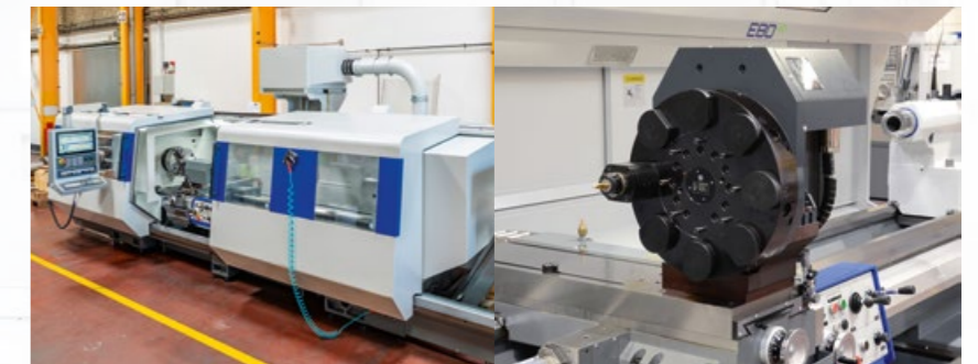
8-fach-Scheibenrevolver mit angetriebenen Werkzeugen, Schaft-ø 40 mm
