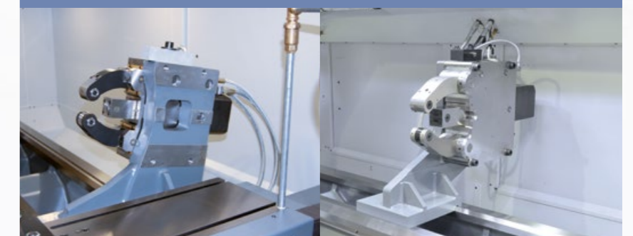
Mitlaufende, selbstzentrierende Lünette, hydraulisch betätigt
