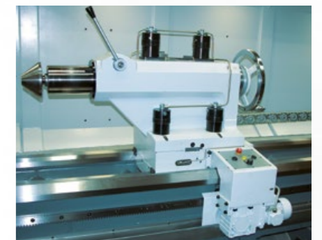
Reitstock mit automatischer Klemmung und eigenem Antrieb
