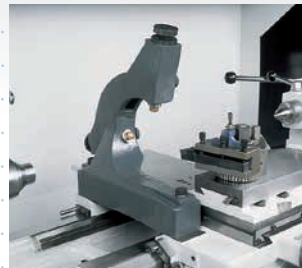
Mitlaufende Lünette mit Gleitbacken Ø 10 – 160 mm
