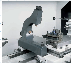
Mitlaufende Lünette mit Gleitbacken Ø 10 – 160 mm
