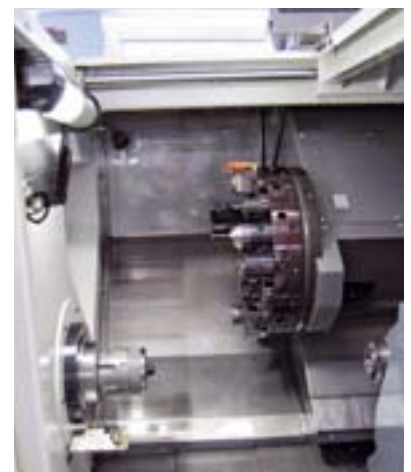
Arbeitsraum der DZ40: Besonders wichtig in der Teilefertigung bei Wolf war neben der Y-Achse, der Scheiben-Revolver mit bis zu 16 angetriebenen Werkzeugen
