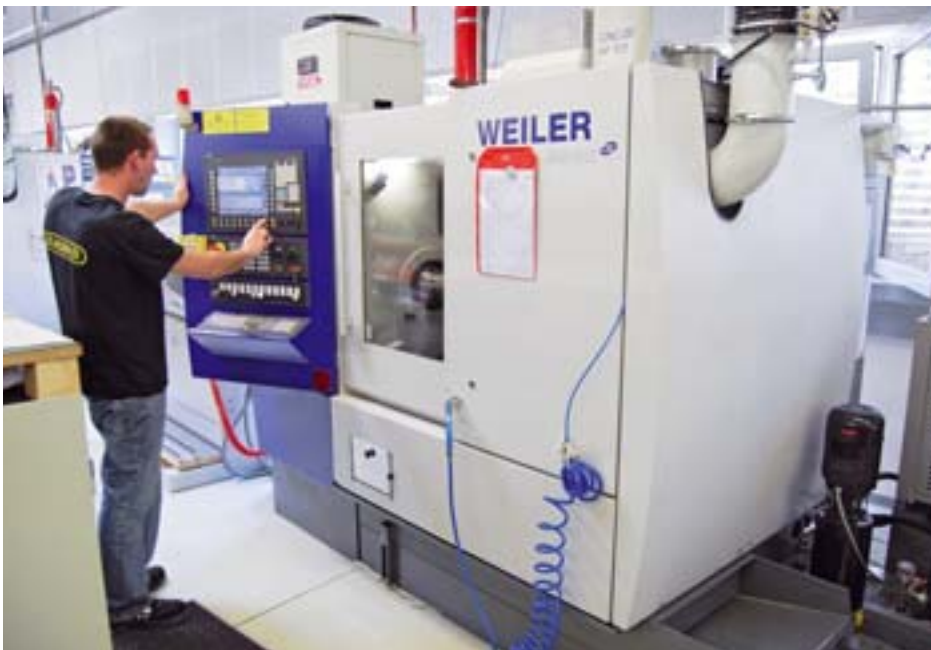
Insgesamt sind über 30 Weiler-Maschinen bei Wolf im Einsatz. Im Bild die DZ40 mit der gemeinsam entwickelten Temperaturkompensation
