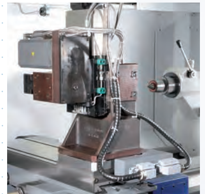
Y-Achse mit 200 mm Hub
