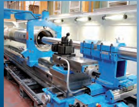
Verstärkter Bohrbock mit zusätzlicher Abstützung und Aufnahmebohrung 160 mm
