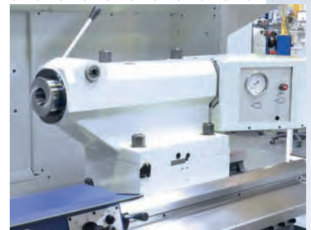
Reitstockpinole hydraulisch betätigt
