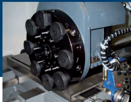
8-fach-Scheibenrevolver mit angetriebenen Werkzeugen, Schaft- \varnothing 40 mm
