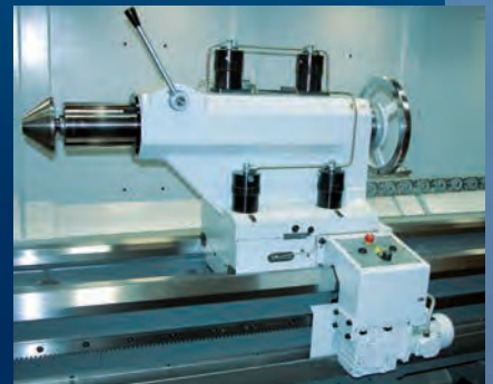
Reitstock mit automatischer Klemmung und eigenem Antrieb
