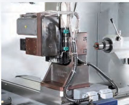
Y-Achse 200 mm Hub (nur bei E110/E120)
