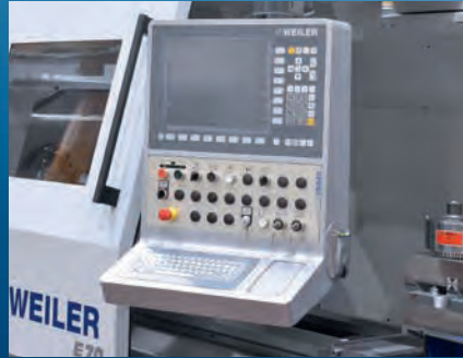
Ausführung mit getrennt verfahrbarem Steuerungsbedienpult
