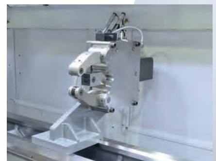
Feststehende, selbstzentrierende Lünette, hydraulisch betätigt
