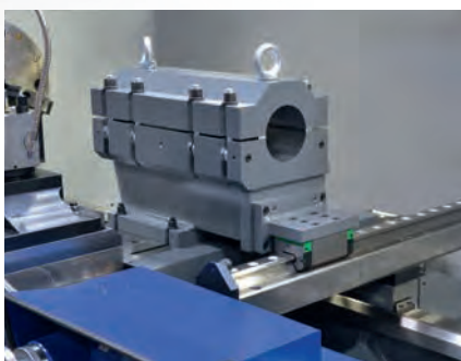
Bohrbock mit zusätzlicher Abstützung
