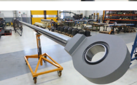
Kolbenstange des Zylinders für Staudammklappe
