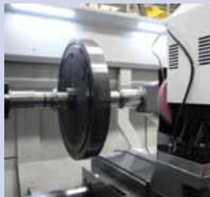
Die Schleifeinrichtung wird für das präzise Druckkamm schleifen von Getrieberädern benötigt.
