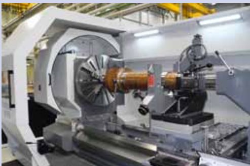
Auf der E175 werden Verdichterwellen und Getrieberäder gedreht.
