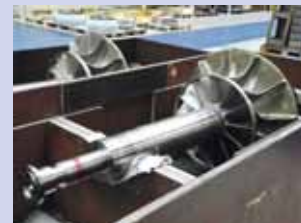
Die auf der Maschine gefertigten Verdichterwellen werden ausschließlich gedreht, die Getrieberäder müssen zusätzlich druckkammgeschliffen werden.
