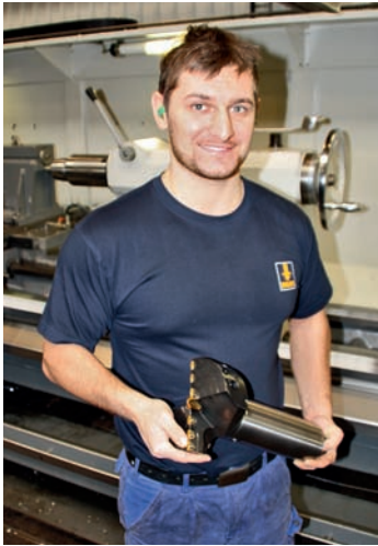
2 6000 Nm am Futter: Bis zu 155 mm \varnothing bohrt die Drehmaschine problemlos ins Volle
