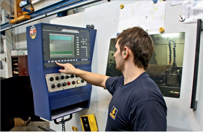
4 Einfach und verständlich: die auf Weiler-Drehmaschinen eingesetzte Weiler-D3-Steuerung für die Zyklenprogrammierung
