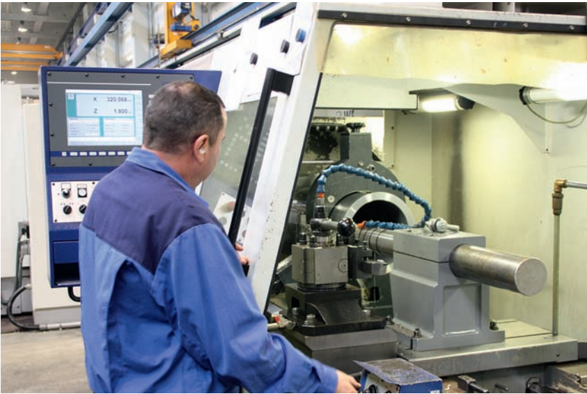
5 Stabile Führung: Mit seiner großen Führungsbreite widersteht der Oberschlitten auch hohen Kippmomenten bei der Schwerzerspannung mit ausragenden Werkzeugen
