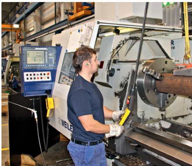
1 Für große Brocken: Sergej Lorenz kann auf seiner Drehmaschine E110 Rohlinge bis 1100 mm Durchmesser bearbeiten
