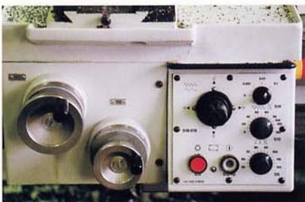
Handrad und Nutzung der Zyklussteuerung als Positionsanzeige sind der angstfreie Einstieg in die CNC-Welt. Übrigens nicht nur in Ausbildungsstätten, sondern auch in Betrieben für ältere Mitarbeiter, die bisher nur an konventionellen Maschinen einsetzbar waren.
