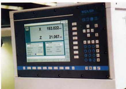
Handrad und Nutzung der Zyklussteuerung als Positionsanzeige sind der angstfreie Einstieg in die CNC-Welt. Übrigens nicht nur in Ausbildungsstätten, sondern auch in Betrieben für ältere Mitarbeiter, die bisher nur an konventionellen Maschinen einsetzbar waren.
