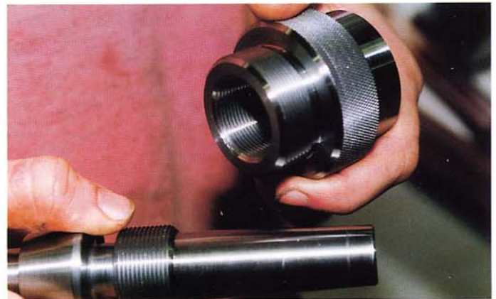
Präzise Maße, hohe Oberflächengüte, Innen- und Außen-gewinde, leichtgängig und trotzdem absolut spielfrei, Kegel, Morsekegel, Rändelung, alles perfekt
