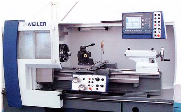
Bild 3: Neuentwicklung in der Flaute: mit der E 55, die zur Hausausstellung vorgestellt wurde, zeigt Weiler antizyklisches Verhalten. Vor allem die jetzt ergonomisch noch günstiger angeordneten Bedienelemente fallen daran auf
