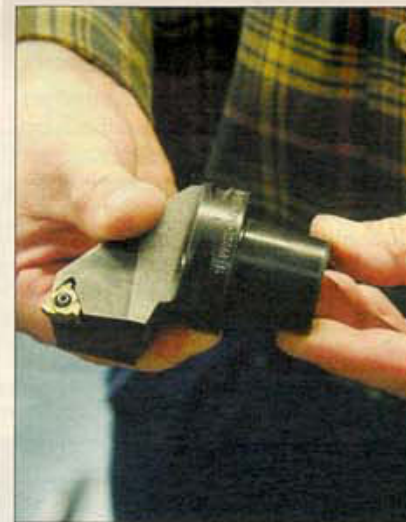
Begeistert ist Peter Benesch auch von den Capto-C5-Aufnahmen von Sandvik. Damit lassen sich Werkzeuge sehr schnell und genau wechseln.
