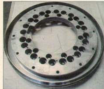
Kunststoffverteiler von oben und unten: Die Bahnen fräst Unicor auf der Zyklendrehmaschine mit einschwenkbarer C-Achse. Bilder: Unicor
